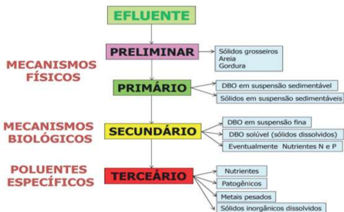
Figura 3. Níveis do tratamento de efluentes.
