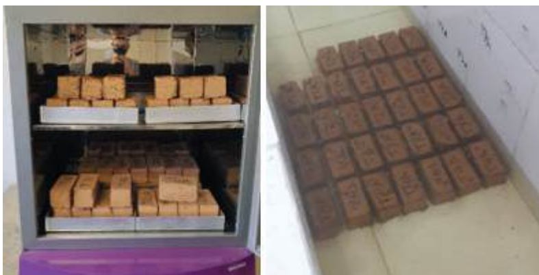
Figura 6. Ensaio de absorção de água.
