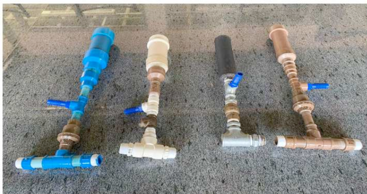
Figura 01 – Carneiros hidráulicos construídos
