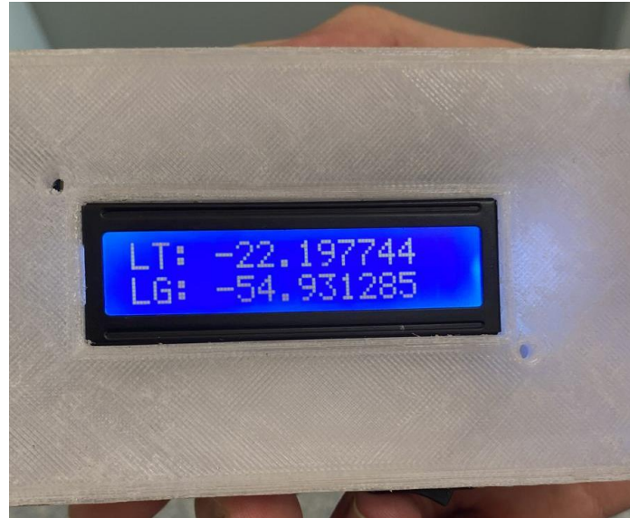
Figura 6: GPS Construído de lixo eletrônico controlado com arduino e o módulo GPS Neo-M6.
