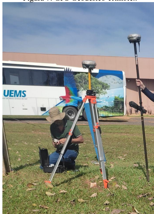
Figura 7: GPS Geodésico Trimble..
