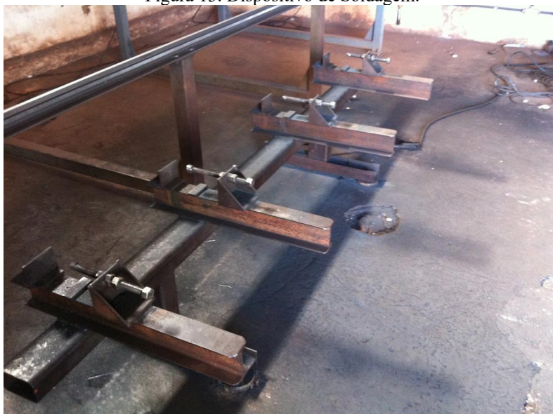
Figura 13. Dispositivo de Soldagem.
