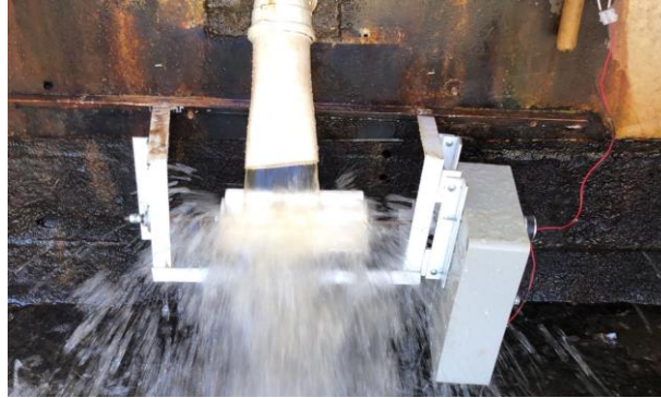
Figura 4 – Roda d’água e gerador acoplados na barragem (condição 3).
