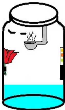
Figura 1 - Esquema de aparelhagem de experimento para simulação dos efeitos da chuva ácida
